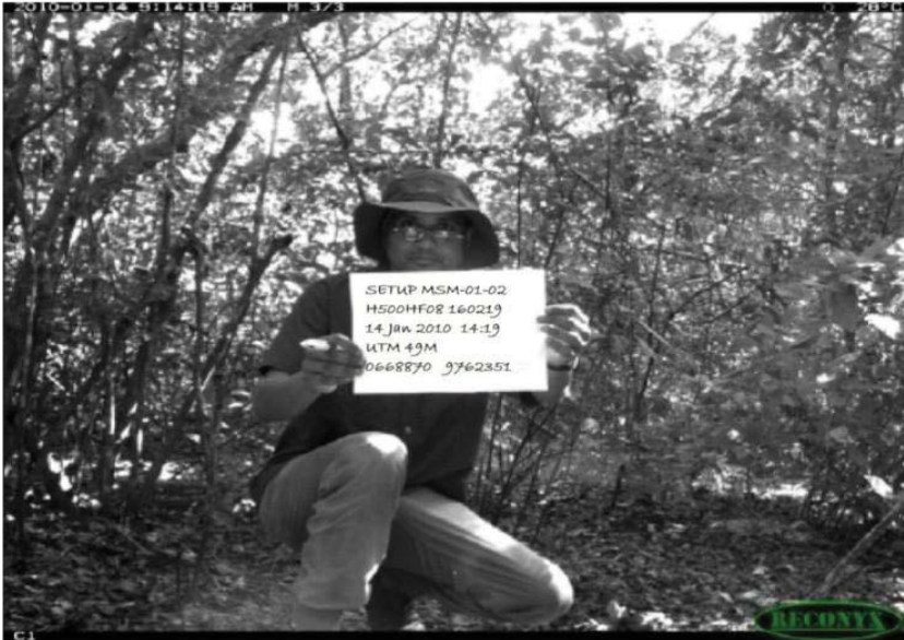
Gambar 17. Pengambilan foto pertama dari kamera trap yang berisi kode kamera, waktu pemasangan dan koordinat lokasi pemasangan kamera
